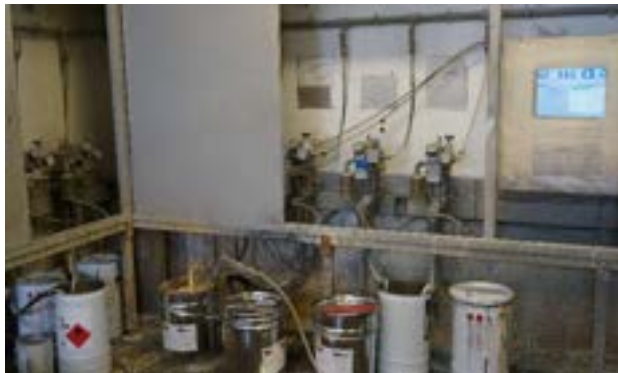
Automatische Spülbox nach erreichter Topfzeit
