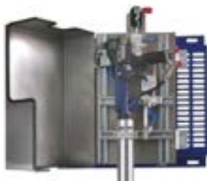
Automatische Spülbox nach erreichter Topfzeit
