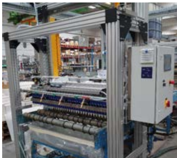
Komplette Linie mit Teileerkennung, Kleber-Raupenauftrag
