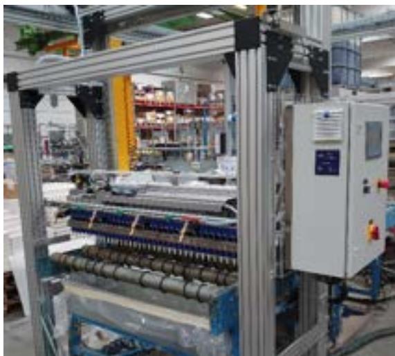
Komplettlinie mit Teileerkennung, Kleber-Raupenauftrag
